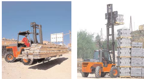
Equip de treball utilitzat per a la manipulació de càrregues en zones amb superfícies planes, preferentment magatzems.
