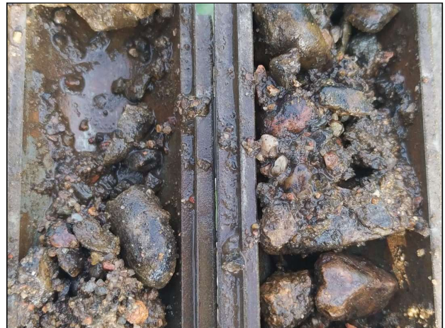
Fotografia 4: vista al detalle del SPT-1 (PD2), extraído a 3,00 - 3,60 metros de profundidad.
