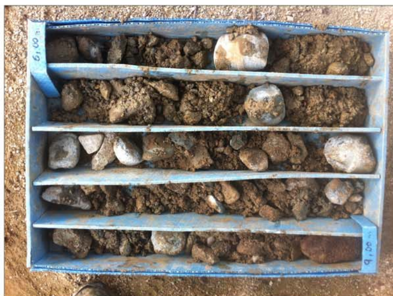
Foto 4: Material perforat entre 6 m i 9 m a S1.
