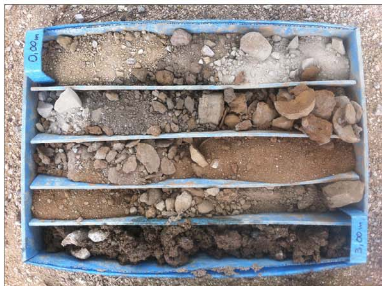
Foto 2: Material perforat entre 0 m i 3 m a S1.
