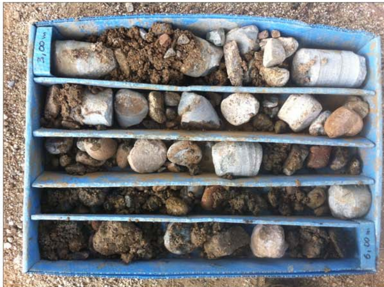
Foto 3: Material perforat entre 3 m i 6 m a S1.
