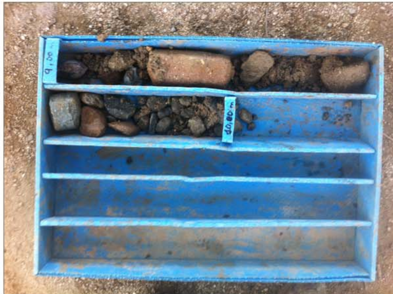
Foto 5: Material perforat entre 9 m i 10 m a S1.
